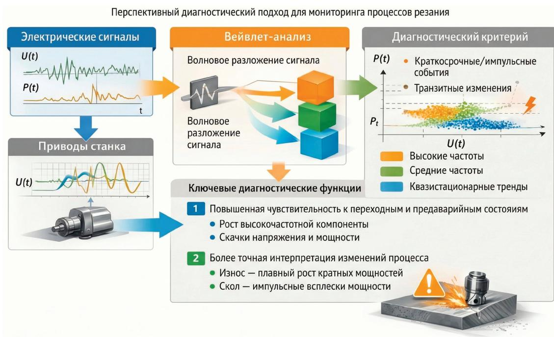
Рис. 3. Волновые критерии зависимости напряжения и мощности [3]
