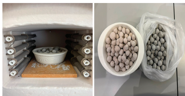
Рис. 7. Обжиг гранул в печи при температурах 950, 1000 °С, время выдержки 1 ч.
