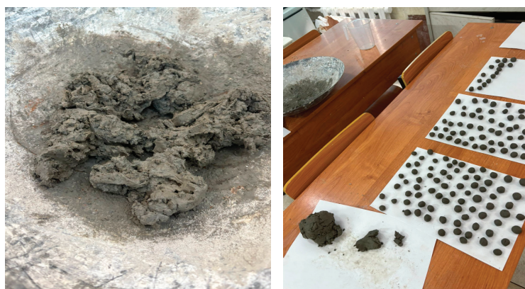
Рис. 4. Процесс подготовки экспериментальной смеси и формирование гранул
