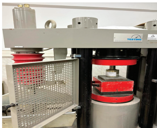
Рис. 9. Определение марки гранул при дроблении
