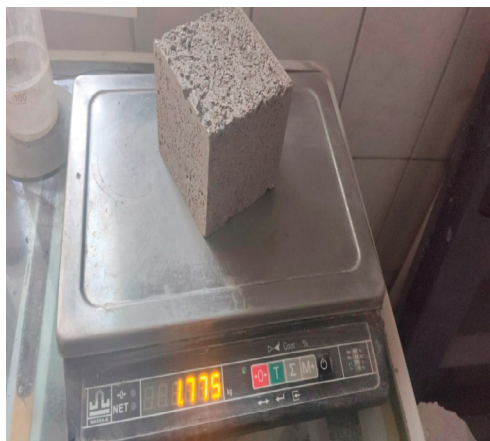
Рис. 12. Взвешивание и определение плотности легкого бетона
