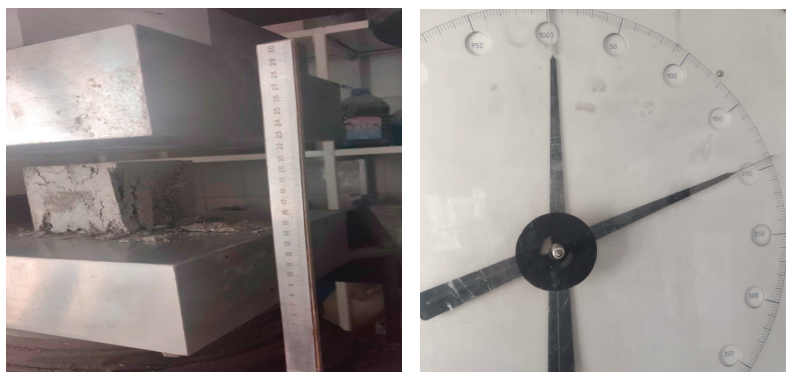
Рис. 13. Определение прочности бетона при гидравлическом прессе
