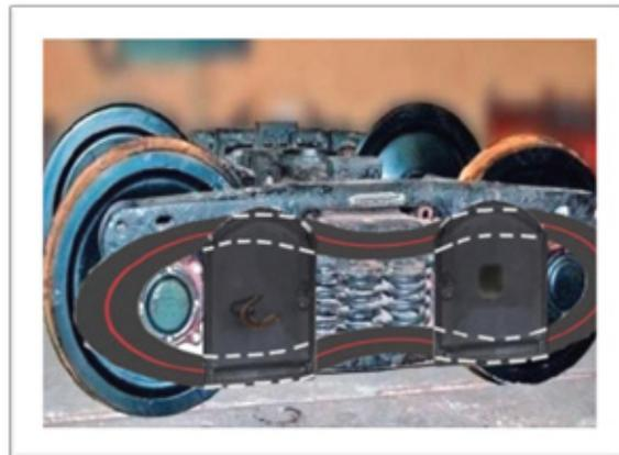
Рис. 14. Составные элементы боковой рамы тележки вагона
