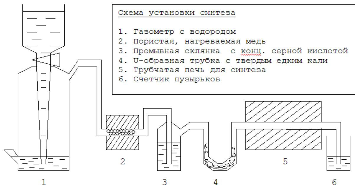
Рис. 1. Установка для синтеза в контролируемой атмосфере
