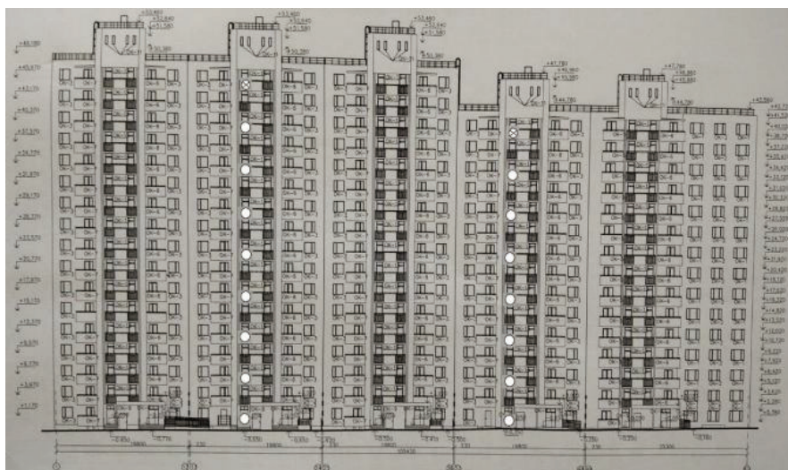
Рис. 7. Схема расстановки измерительных модулей в здании, вертикальный створ
