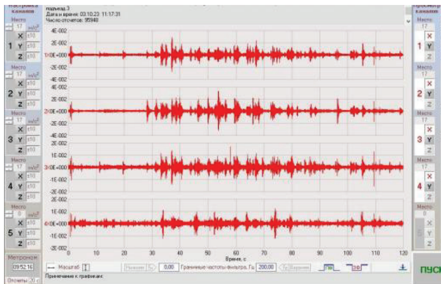
Рис. 8. Сигналы ускорений колебаний и спектры сигналов ускорений колебаний обследуемого здания, после силовых воздействий порывов ветра вдоль длинной и короткой сторон здания во 2-м и 4-м подъездах
