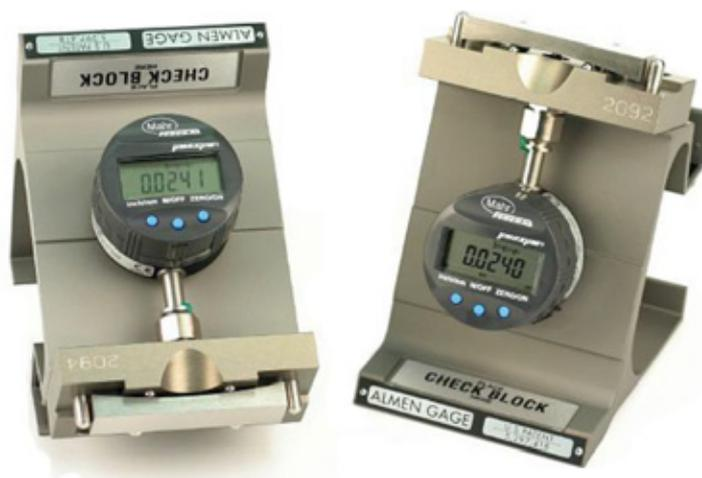
Рис. 1.1. Современные приборы TSP-3 для измерения интенсивности Almen согласно стандарту SAE J442
