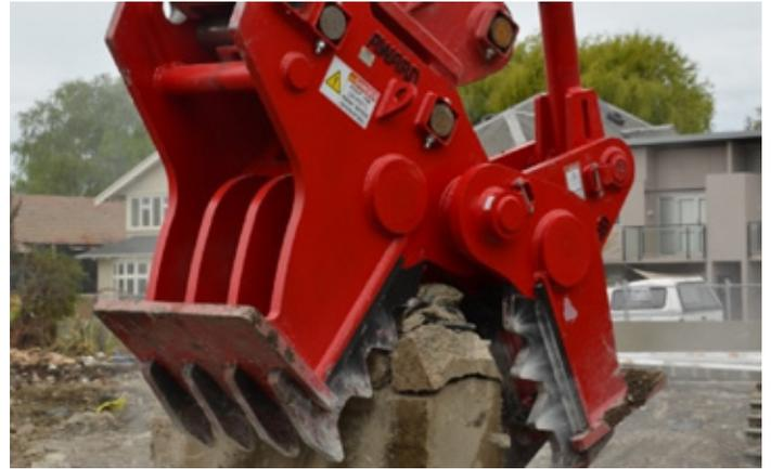
Рис. 4. Измельчитель бетона
