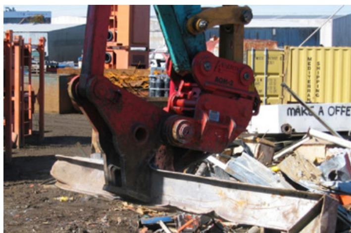
Рис. 2. Ножницы для металла
