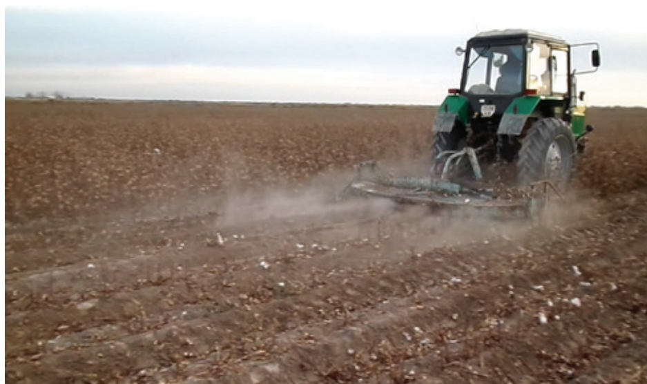
Рис. 2. ISX-3,6 измельчитель стеблей хлопчатника в полевых условиях
