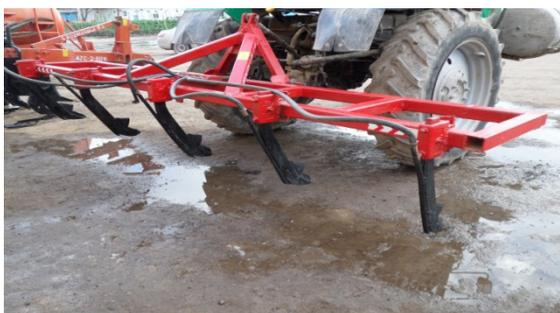
Рис. 3. Общий вид культиваторов растениепитателей КР-5-40
