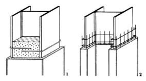
Рис. 4. Обетонирование металлических конструкций (1 — с использованием хомута, 2- с использованием арматурной сетки)
