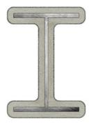
Рис. 2. **Огнезащита металлических конструкций** при помощи огнезащитных красок
