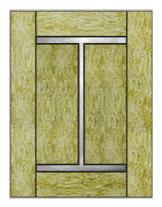
Рис. 1. Огнезащита металлических конструкций про помощи облицовочных материалов
