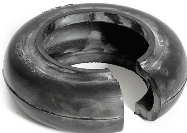
Рис. 2. Оборванная резинокордная муфта
