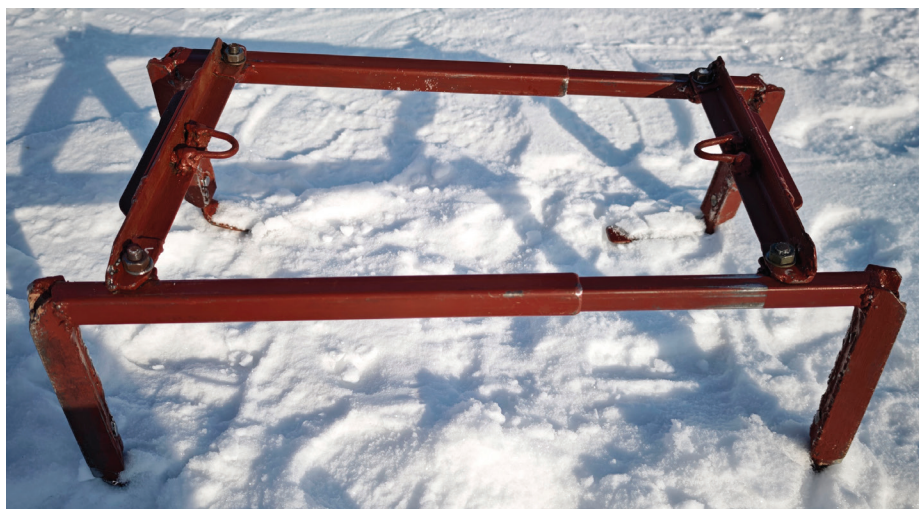
Рис. 2. Противобуксовочное приспособление
