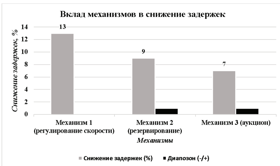
Рис. 10. Вклад каждого из трёх предложенных механизмов в общее снижение задержек по результатам имитационного моделирования
