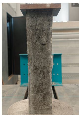
Рис. 13. Бетон с содержанием полипропиленового волокна 1,5 %
