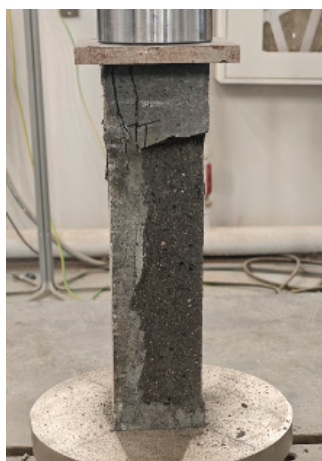
Рис. 12. Бетон с содержанием полипропиленового волокна 1 %
