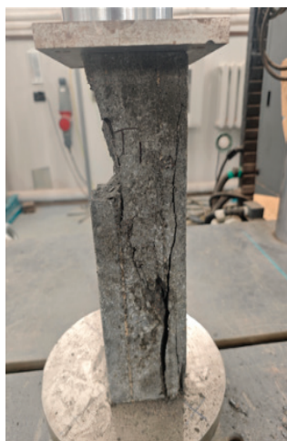
Рис. 11. Бетон с содержанием полипропиленового волокна 0,5 %
