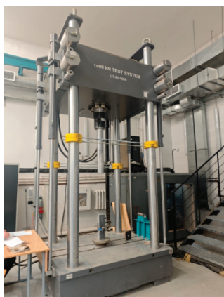
Рис. 8. Машина для испытаний на сжатие
