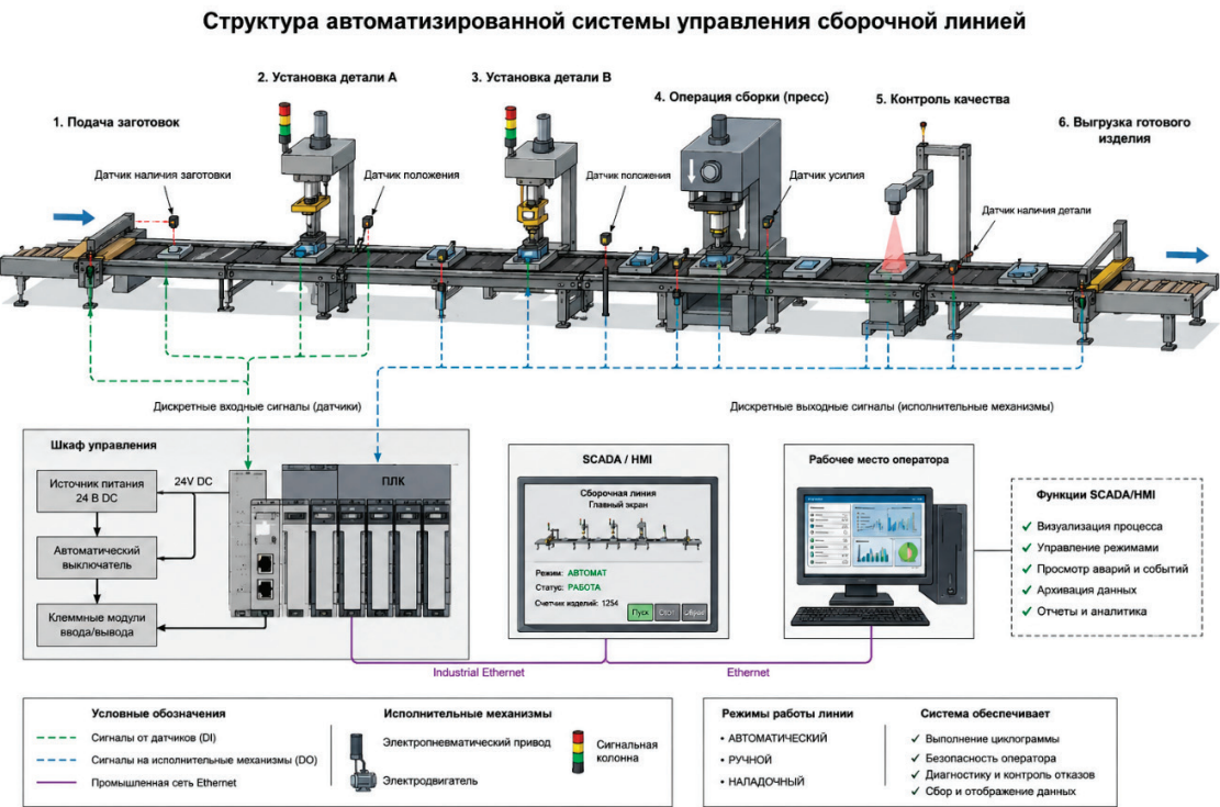
Рис. 1. Структура автоматизированной системы управления сборочной линией на базе ПЛК и SCADA/HMI-системы
