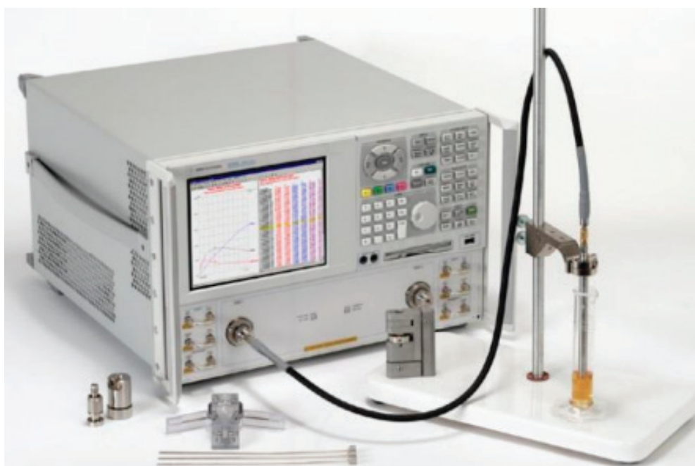
Рис. 4. Установка с использованием коаксиальных пробников
