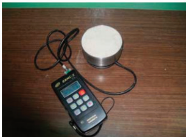
Рис. 1. Общий вид электроемкостного прибора ВИМС-2.21
