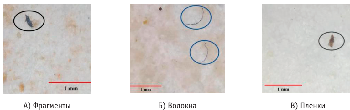
Рис. 2. Изображения частиц микропластиков, обнаруженных в плодах и овощах
