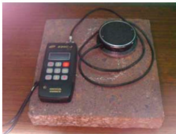
Рис. 1. Общий вид электроемкостного прибора ВИМС-2.21
