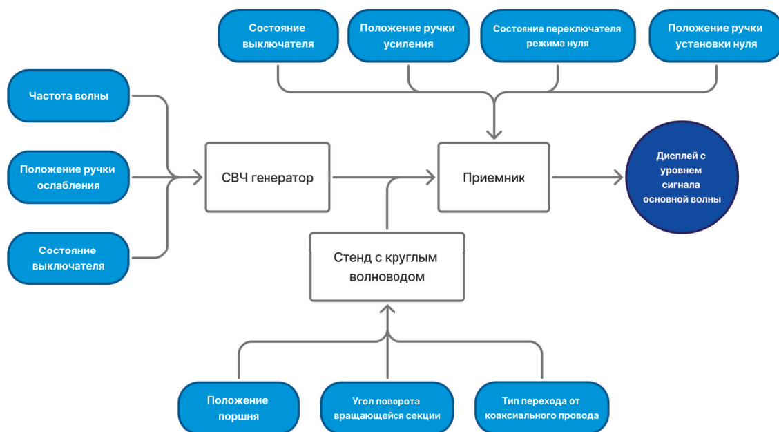
Рис. 2. Диаграмма компонентов имитационной модели лабораторной установки
