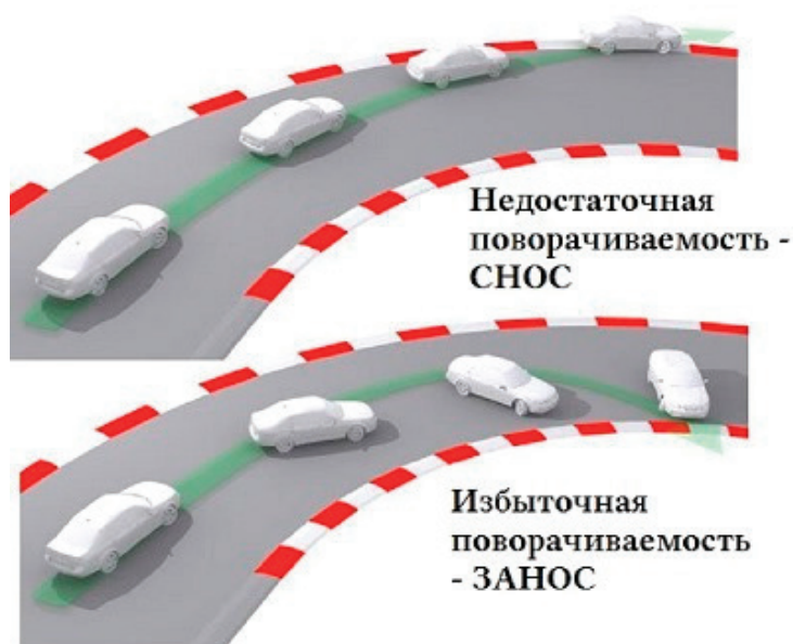
Рис. 9. Критические режимы при повороте автомобиля [8]
