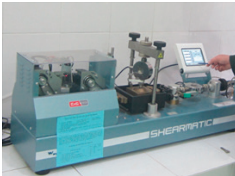
Рис. 2. Автоматический прибор прямого сдвига модели SHEARMATIC
