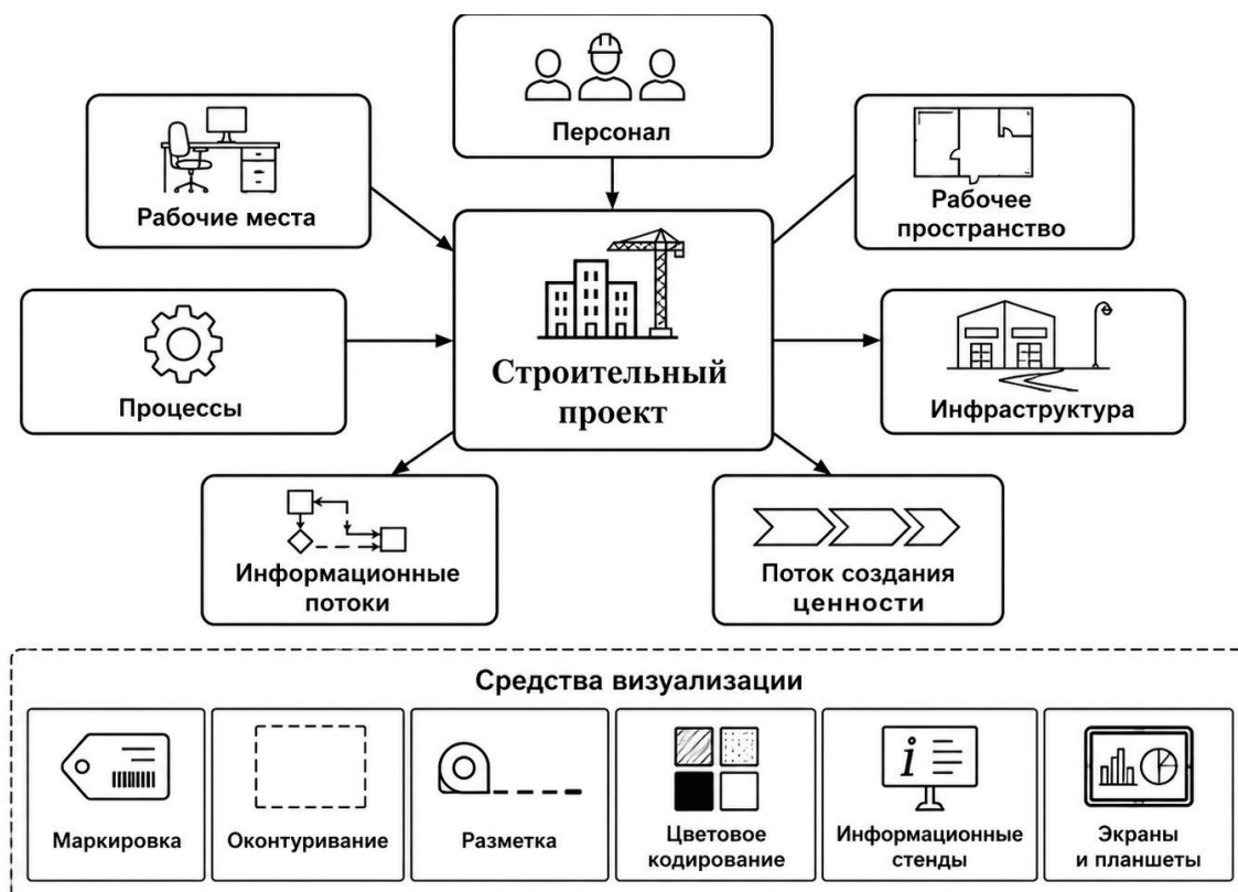
Рис. 1. Структура визуализации строительного проекта
