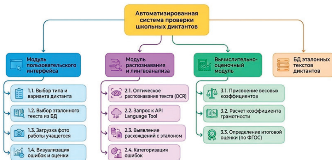
Рис. 1. Общая схема автоматизированной системы проверки школьных диктантов
