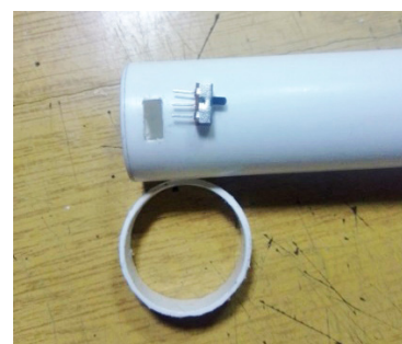
Рис. 9. Место установки переключателя
