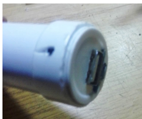
Рис. 12. Клеевое крепление платы и переключателя
