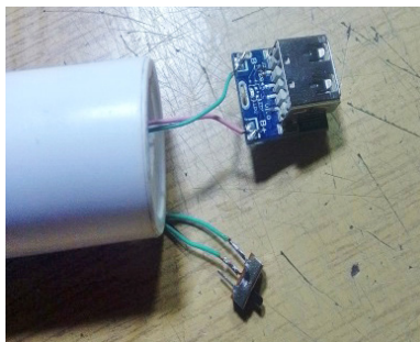
Рис. 10. Припаивание проводов к зарядному устройству и кнопки
