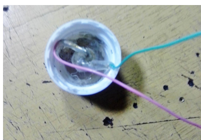
Рис. 5. Техника крепления «линза и провода» с помощью циакринового клея
