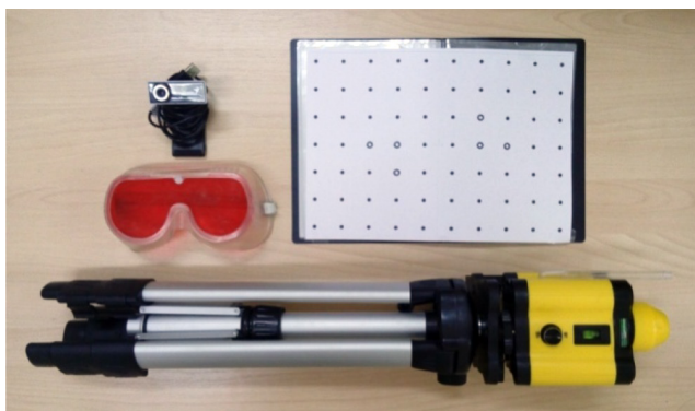
Рис. 1. Материалы для создания 3d сканера
