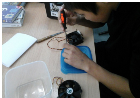
Рис. 1. Делаем крепления в крышке контейнера для кулера, с помощью саморезов и отвертки
