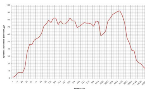
Рис. 4. Исследование АЧХ наушника Sennheizer MX500
