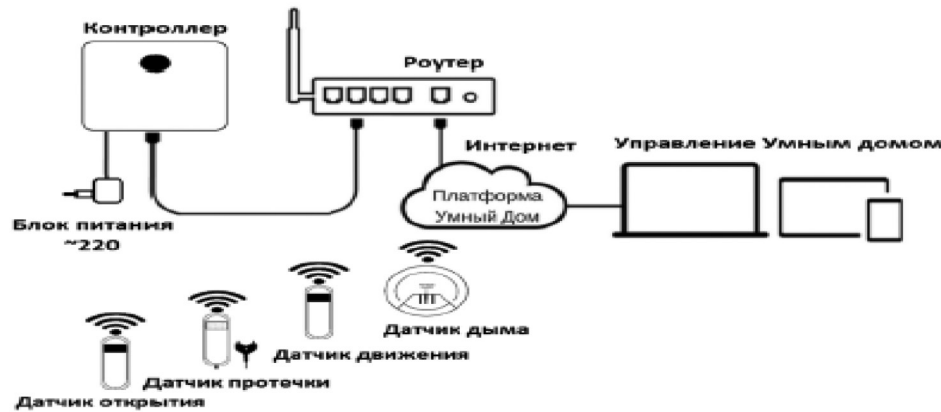
Рис. 5. Схема подключения контроллера для различных датчиков, работающих по Wi-Fi
