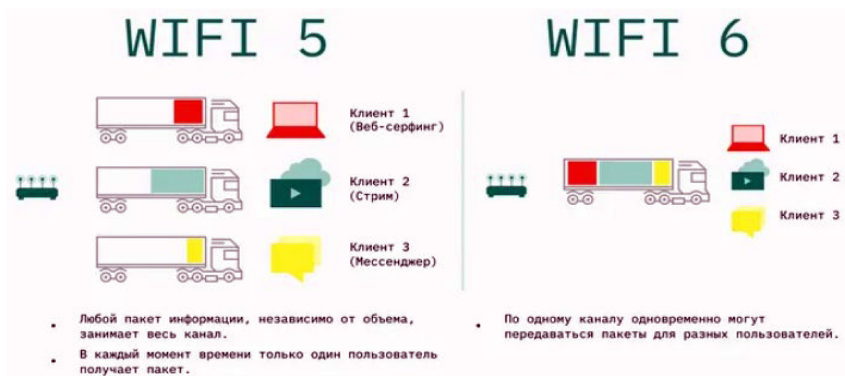
Рис. 9. Разница передачи пакетов в сетях Wi-Fi 5 и Wi-Fi 6
