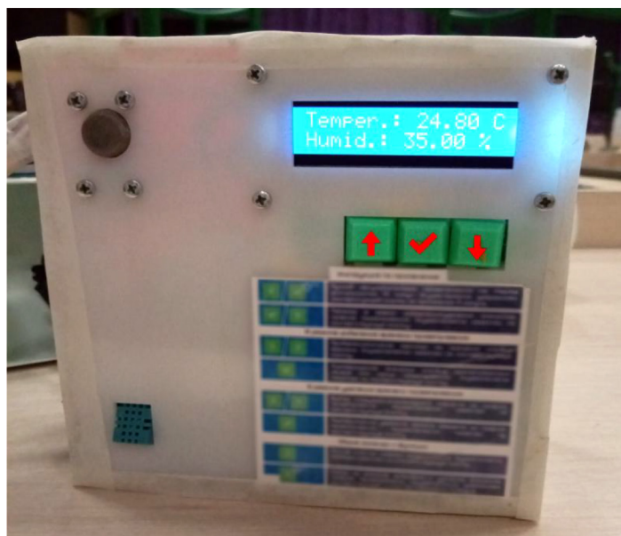
Рис. 4. Модуль управления и компоненты слева направо: сверху — датчик углекислого и угарного газов MQ-135, ЖК дисплей, три кнопки управления; снизу — датчик температуры/влажности DHT-11, руководство по эксплуатации
