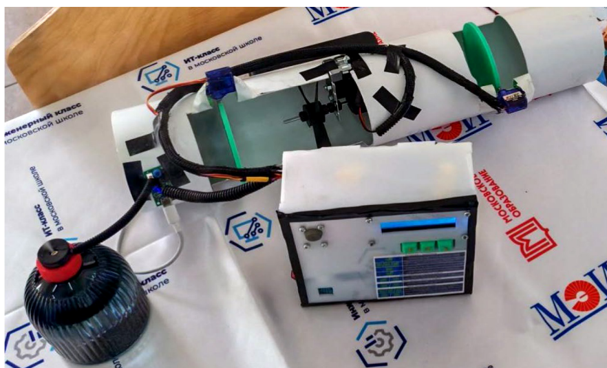
Рис. 2. Прототип SUP-4. Компоненты слева направо: увлажнитель; воздуховод с клапанами (зелёные), фильтрами и вентилятором; модуль управления
