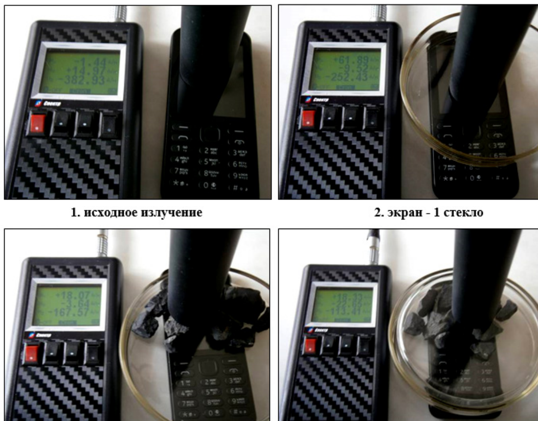
Рис. 7. Этапы и результаты измерения напряжённости электромагнитного поля сотового телефона Nokia при различных способах экранирования излучения
