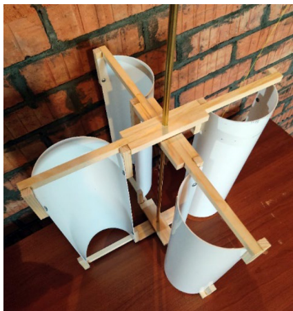
Рис. 8. Изготовление ротора
