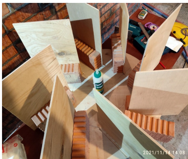
Рис. 6. Приклеивание неподвижных лопастей
